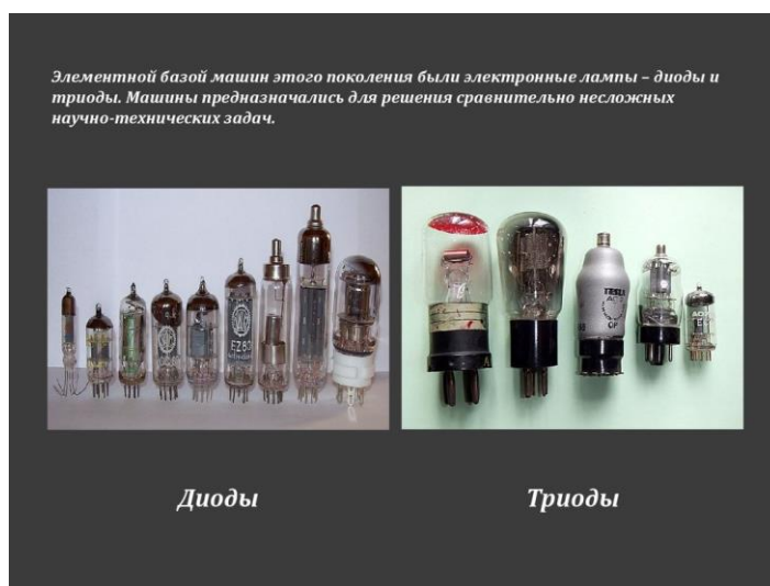
Рисунок 2 - Первые электронные лампы: диод и триод
